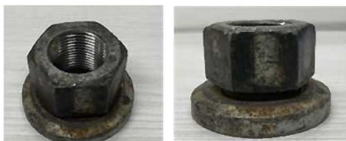
車輪脱落事故を起こした車両の ワッシャー付ホイール・ナット
