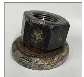
劣化したホイール・ナット
