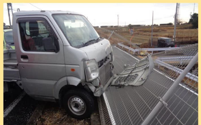
待機列にて、前の車両に続き前進した際にペダルを踏み間違い、他の受検車両及びフェンスに衝突。
